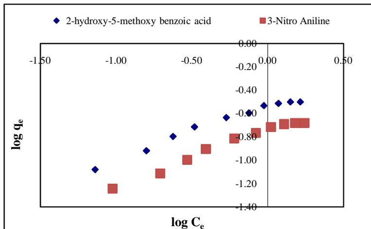
Fig. 3 : Freundlich adsorption isotherm system : F-816<sub>Co<sup>2+</sup></sub> at 298 K
